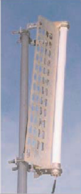
شكل 5: هوائي قطاعي Sectorial Antenna (A2.45LP14 180°)
